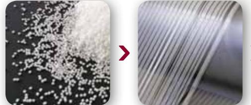
Hergestellt aus 100% reinem Polypropylen-Granulat. Das Granulat wird geschmolzen und zu einer dünnen Polypropylen-Platte verarbeitet. Diese Platte wird in dünne, 1 cm breite Streifen geschnitten.
